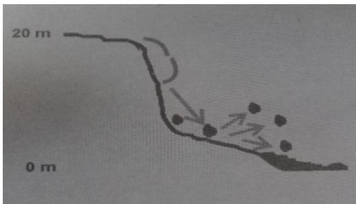
**Imagen 2. Esquema de un caído o derrumbe**
